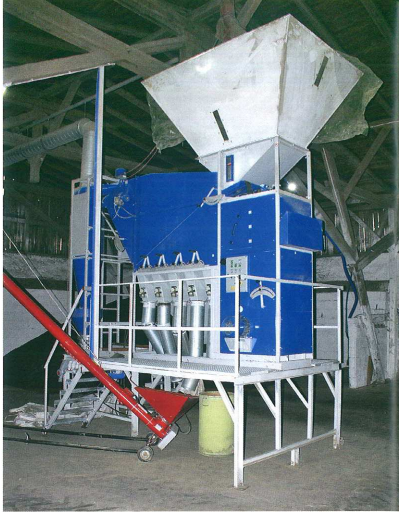
Separator firmy ASM Technology użytkowany w Gospodarstwie Rolno-Hodowlanym Żydowo charakteryzuje łatwa obsługa (w środku panel sterowania, po prawej zasuw regulacyjne). We własnym zakresie wykonano koszt przyjęciowy do separatora (na zdjęciu z lewej).
