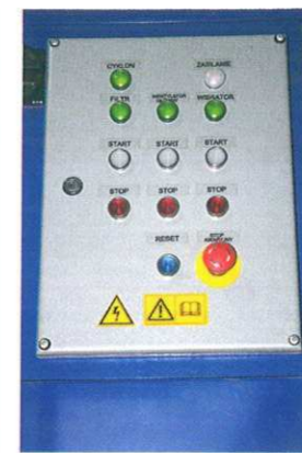
Separator firmy ASM Technology użytkowany w Gospodarstwie Rolno-Hodowlanym Żydowo charakteryzuje łatwa obsługa (w środku panel sterowania, po prawej zasuw regulacyjne). We własnym zakresie wykonano koszt przyjęciowy do separatora (na zdjęciu z lewej).
